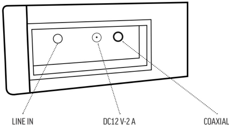
Připojení pomocí dodaného kabelu Jack z výstupu sluchátek televizoru
